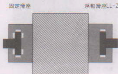
圖26.7 Y方向浮動滑座的垂直安裝
