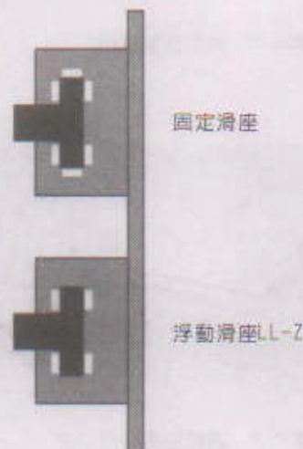
圖26.6 Z方向浮動滑座的側向安裝
